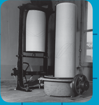
Marégraphe à tambour OTT 3068 modèle 10030
