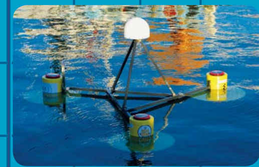
Nouvelles techniques d'observation. Marégraphe radar (haut) et bouée GPS (bas)
