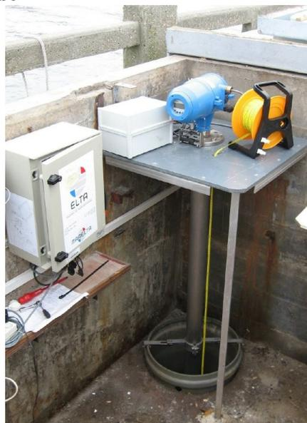
**Les plages de mesures du contrôle doivent être identiques à celle du marégraphe.**
