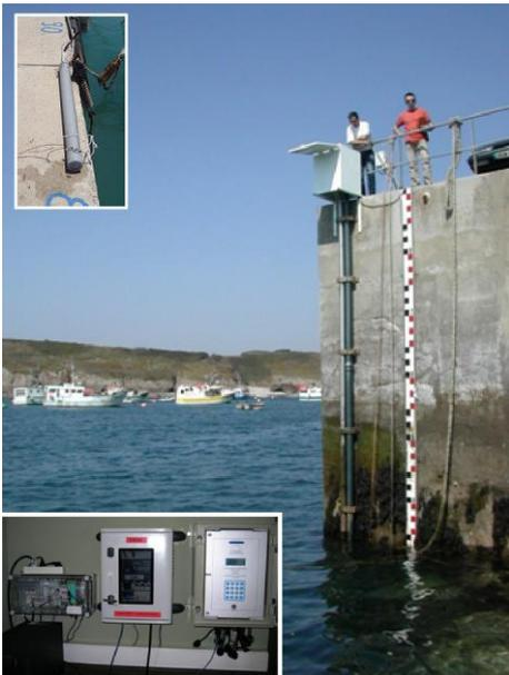
Echelle de marée, marégraphe radar ( à quai ), marégraphe à capteur de pression et équipement à installer dans l'abri prévu en début de jetée.
