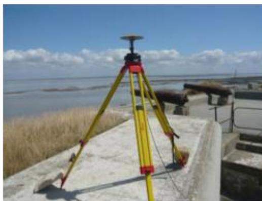
*photo 2 : l'antenne GPS près des canons*
