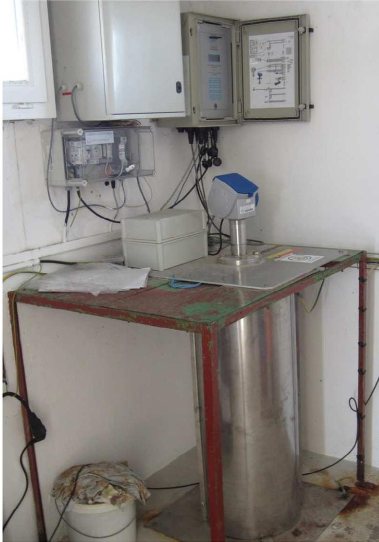
**Figure 25 : MCN radar et centrale d'acquisition en place actuellement à Saint-Nazaire (Photo SHOM, 2014)**
