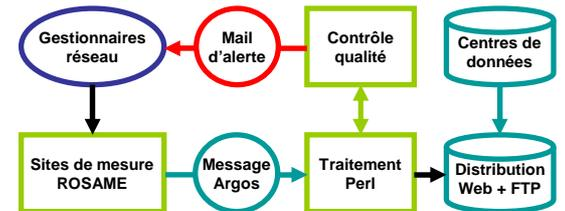
Figure 4. Schéma de fonctionnement du traitement des mesures.
