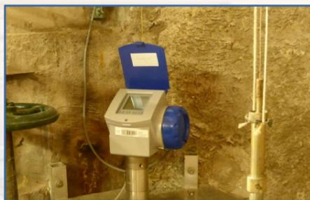
Antenne de la station GNSS permanente (à gauche) et capteur radar du marégraphe numérique (à droite)
