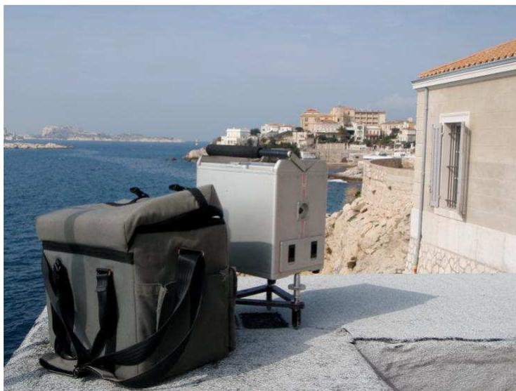
*Gravimètre relatif CG-5 sur le toit du bâtiment technique du Marégraphe.*
