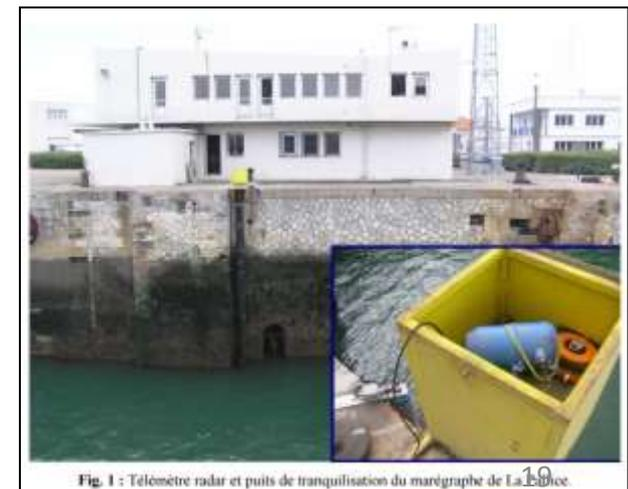
Fig. 1 : Télémètre radar et puits de tranquillisation du marégraphe de La Rochelle.
