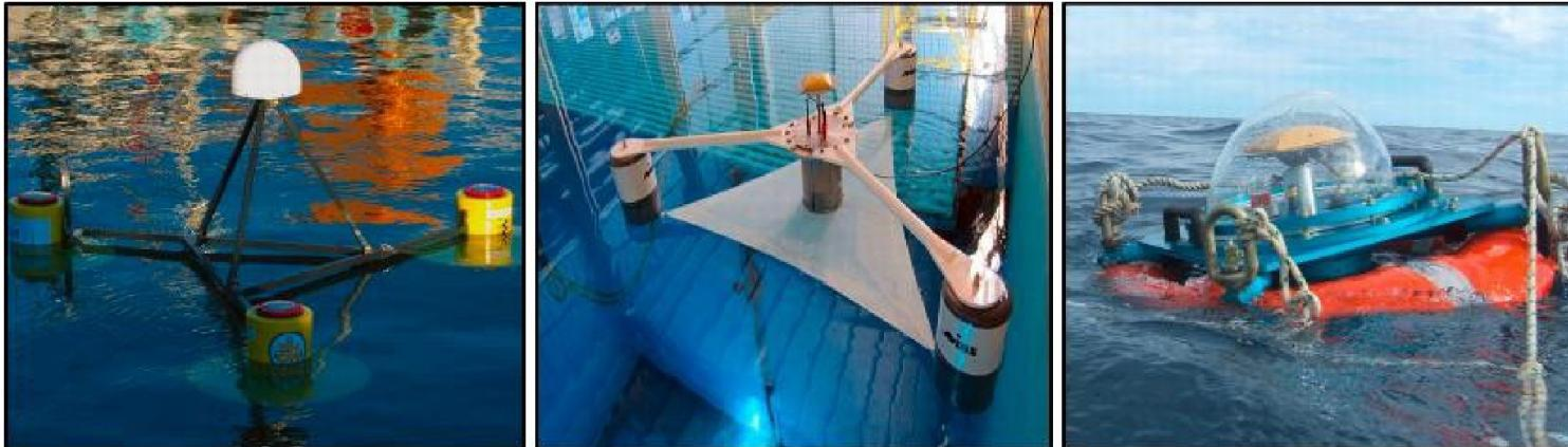
Figure 2. Les trois bouées GPS. SHOM (à gauche), INSU (au centre) et IPGP (à droite)
