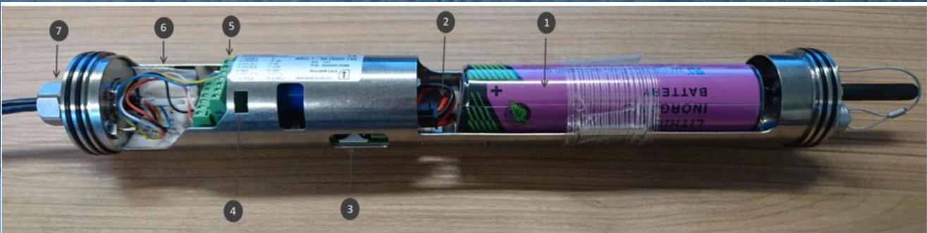
Le GSM-2 de KELLER fournit un moyen simple de suivre à distance les mesures de pression, les niveaux de remplissage et d'eau, et de surveiller les valeurs limites. Cet enregistreur de données avec son unité de transmission de données à distance est le ARC-1, le collecteur de données à distance autonome.
