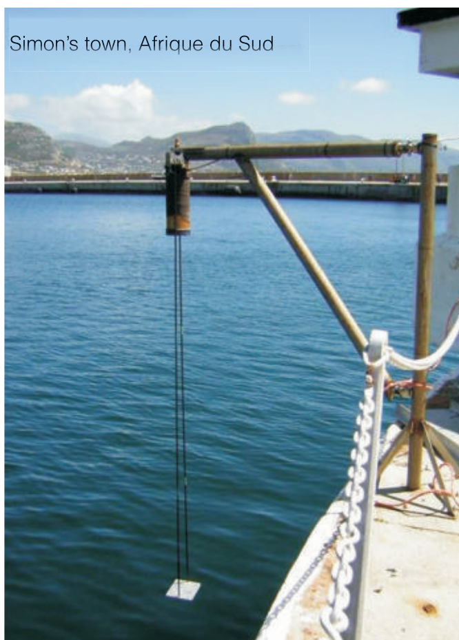
Figure 4.12 Exemples de l'utilisation de la cible « en étrier » à Luderitz en Namibie et Simon's Town en Afrique du Sud. (Photos Ruth Farre, Service hydrographique de la marine sud-africaine).
