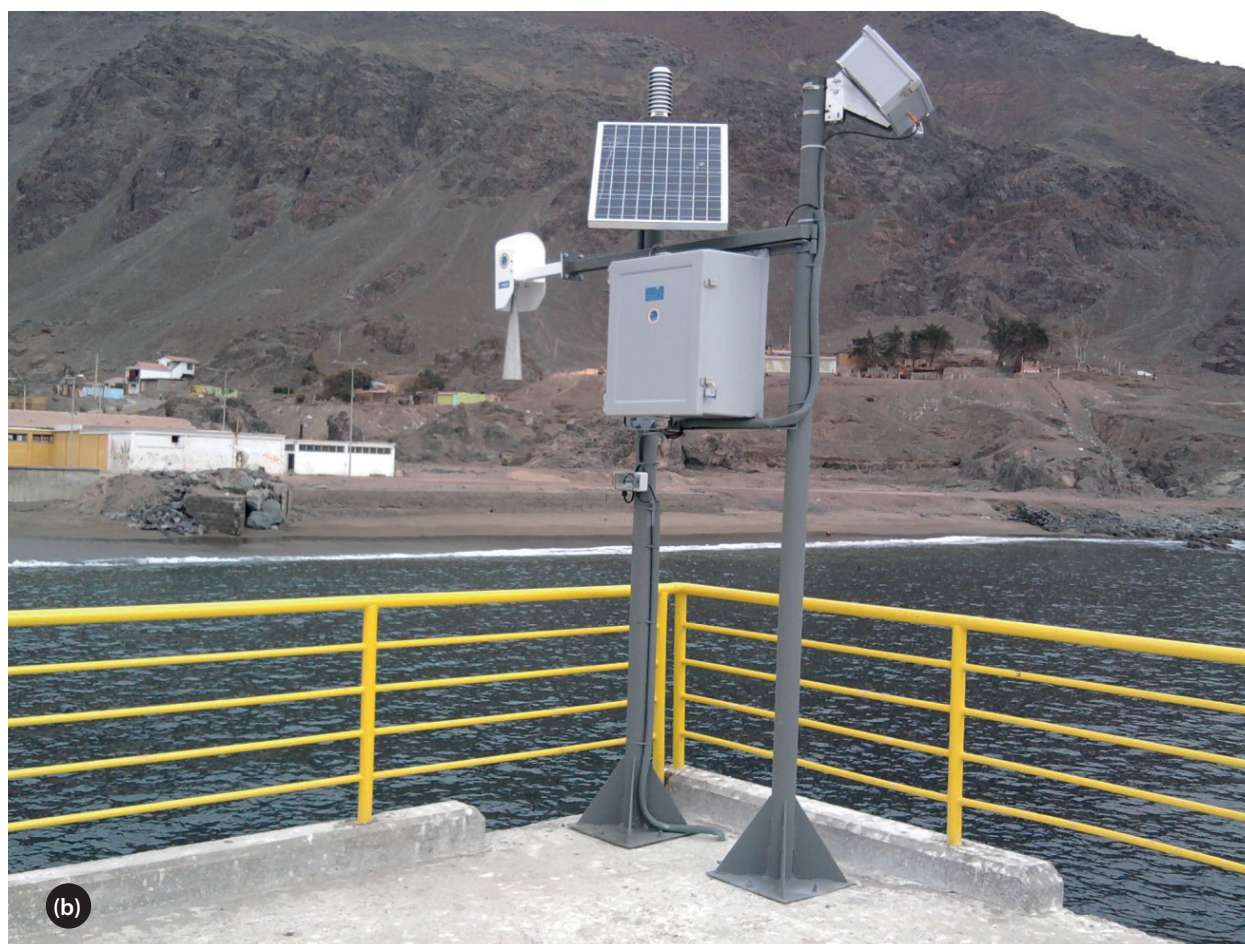
Figure 7.9 (b) Un terminal BGAN similaire à Taltal au Chili. L'antenne (également un T&T Explorer 300) se trouve dans la boîte au coin supérieur droit de la photo. (Photo SHOA).
