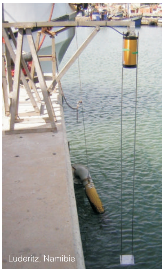
Figure 4.12 Exemples de l'utilisation de la cible « en étrier » à Luderitz en Namibie et Simon's Town en Afrique du Sud. (Photos Ruth Farre, Service hydrographique de la marine sud-africaine).
