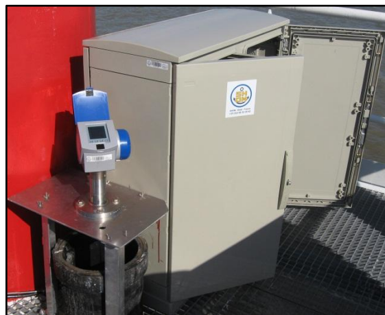
Marégraphe radar à ondes guidées
