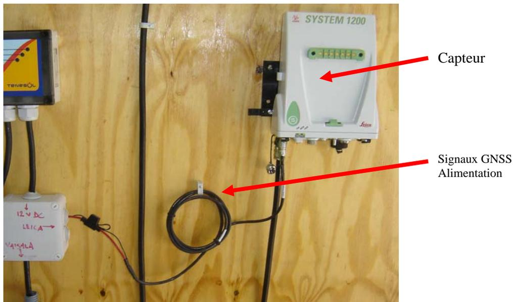
Le capteur ne possède ni commande, ni affichage, et doit être paramétré à l'aide d'un PC par une connexion Ethernet. Le paramétrage actuel est :
