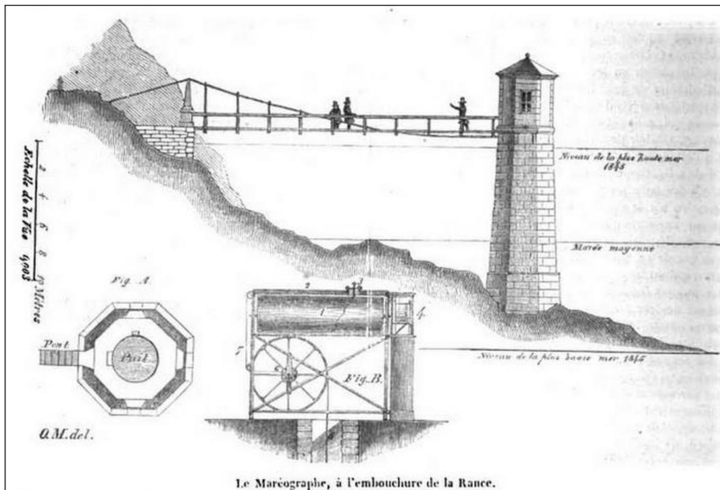
**Figure 3: Plan du marégraphe de Saint-Servan (source : le magasin pittoresque de 1848<sup>2</sup>)**
