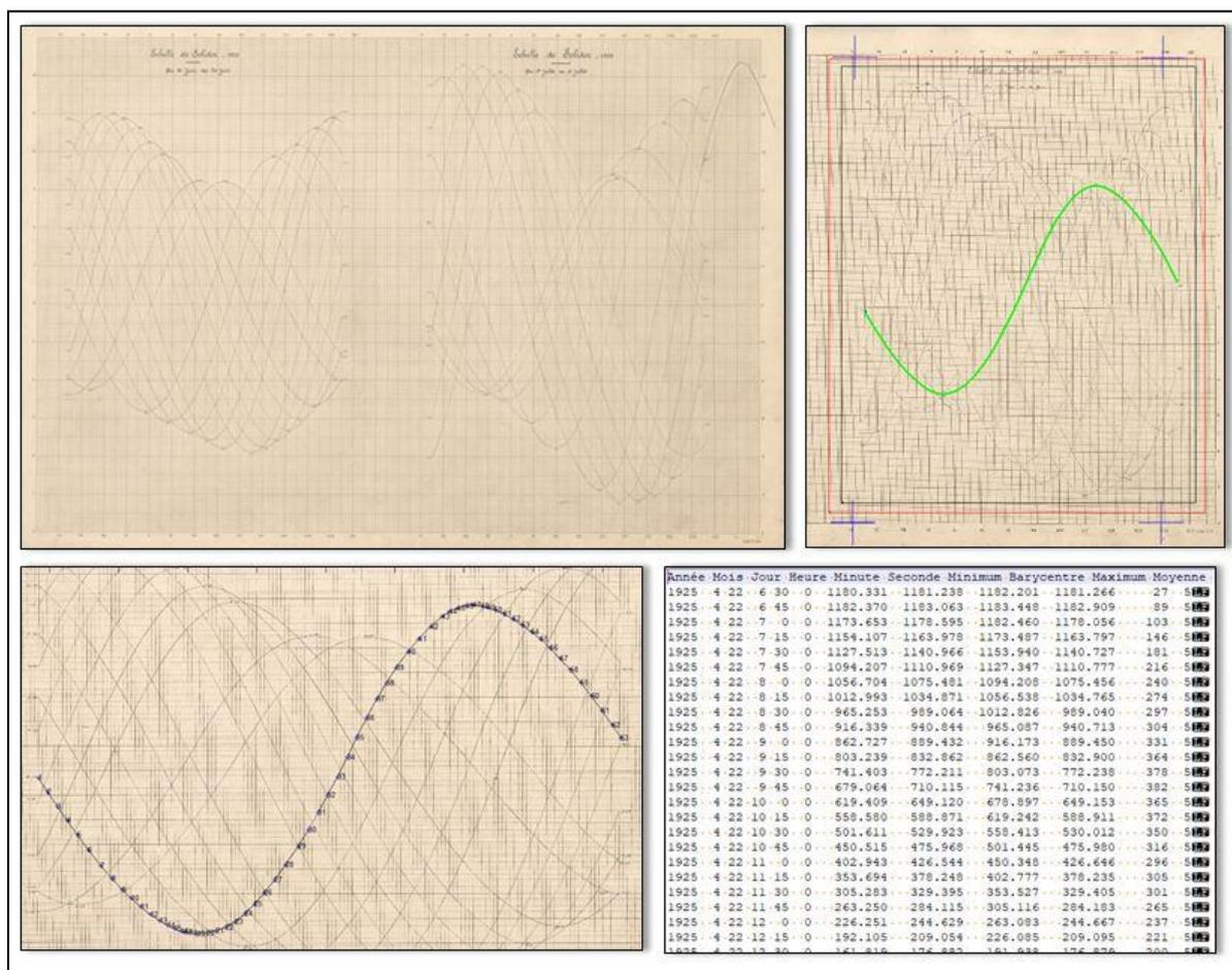
Figure 9 : Illustration des étapes à suivre pour digitaliser une courbe de marée avec NUNIEAU. Les marégrammes de St Malo dans les années 1920 comprennent des courbes sur des périodes d'un mois.
