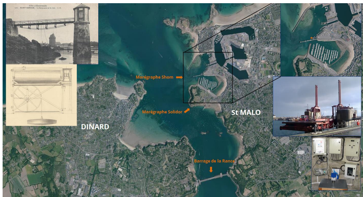
Figure 1 : Localisation des marégraphes de Saint-Malo et de Saint-Servan (photo aérienne géoportail, 2019). Le marégraphe utilisé par EDF se trouve à l'intérieur de la tour hexagonale dans l'anse de Solidor à Saint-Servan et le marégraphe du Shom est situé au terminal du Naye à Saint-Malo.
