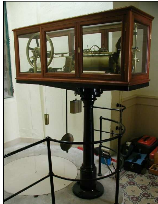
Figure A.5 : Vue du marégraphe de Marseille
