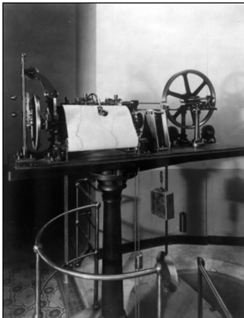
Figure A.4 : Vue du marégraphe totalisateur de Marseille (Image numérisée à partir d'une photo des archives de l'IGN) [WOP 97]
