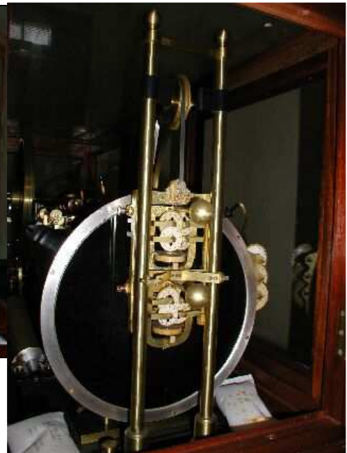
Figure A.7 : Vue du disque totalisateur
