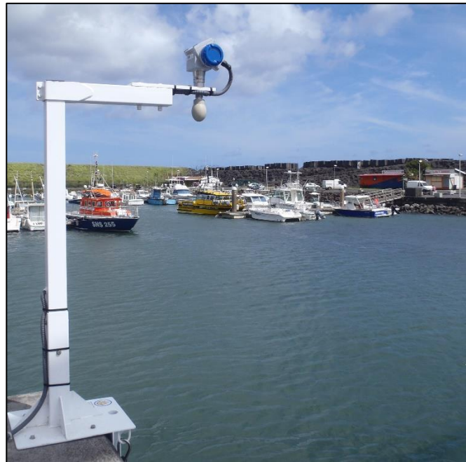
Figure 3 - Marégraphe KHRONE Optiwave déployé à Sainte-Marie (La Réunion) - RONIM (Crédits SHOM, Noé Poffa, octobre 2011).
