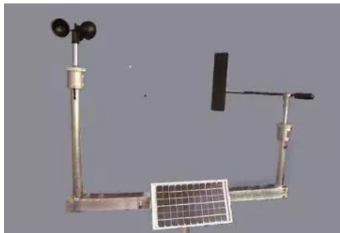
Figure 3 : Ensemble de mesure du vent (anémomètre et girouette) (Source : Météo-France)
