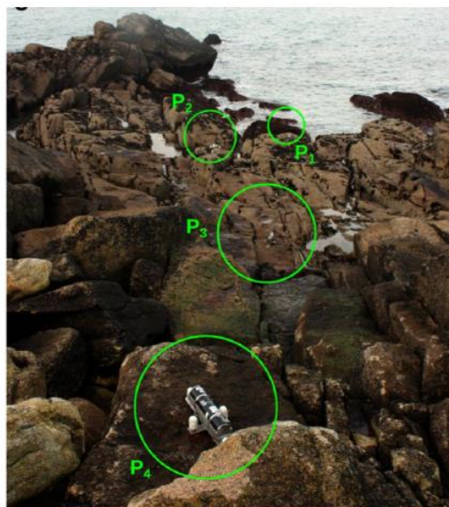
Figure 8 - Système de mesure du run-up sur la côte rocheuse de l'île Banneg (Dodet et al. , 2018)
