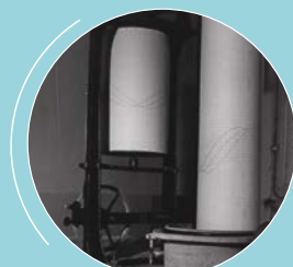
marégraphe mécanique à flotteur
