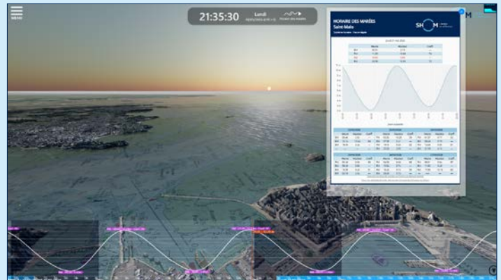
Prototype Shom de jumeau numérique pour la navigation - zone de Saint-Malo - navigation dans l'espace et dans le temps - visualisation des hauteurs d'eau prédites
